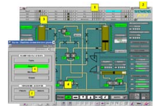
Рис. 11. Главный рабочий экран, управления операциями отдельного затвора
